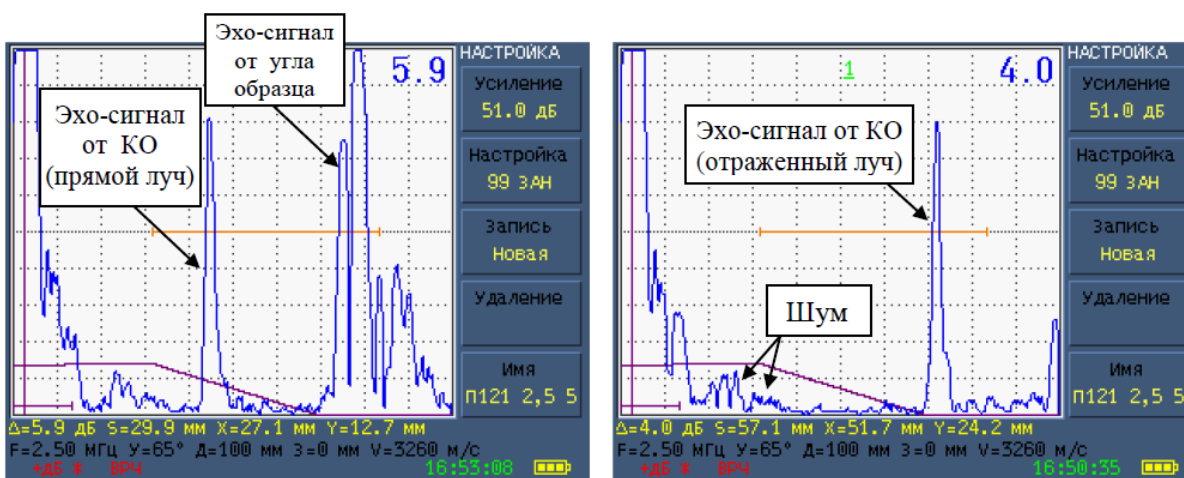
Типовые А-Сканы, получаемые при выявлении зарубки 2x2 мм в СОП Ø219x12 прямым и отраженным лучами ПЭП типа П121-2,5-51-d219-03
