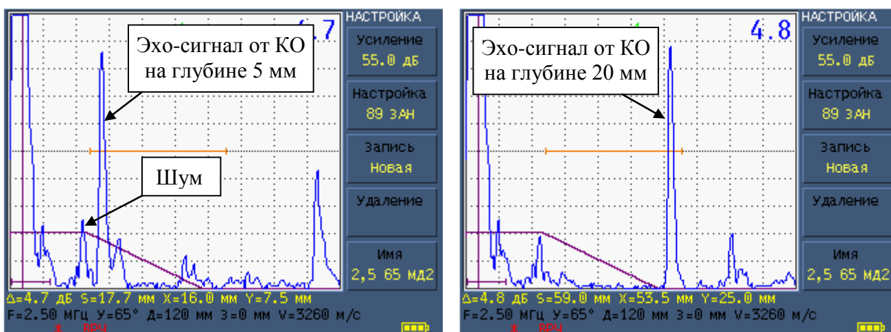
Типовые А-Сканы, получаемые при выявлении КО на глубине 5 и 20 мм в образце МД2-0-1 ПЭП типа П121-2,5-65-В5-03
